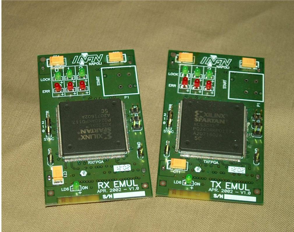
Figura 5.37 Le schede TX ed RX utilizzate per il collaudo dei serializzatori
