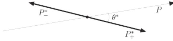
Figura 1.3: Definizione dell'angolo  $\theta^*$ :  $P$  è l'impulso della  $J/\psi$  nel sistema di riferimento del laboratorio,  $P_{\pm}^*$  l'impulso dei muoni positivo e negativo nel sistema del centro di massa del mesone.
