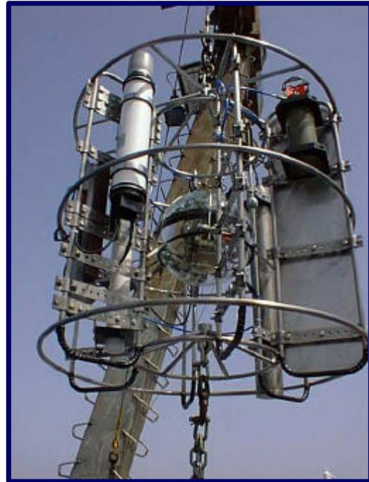
Fig. IV.16 - La stazione di misura sottomarina per la misura dell'effetto del bio-fouling su pareti di vetro. Sono visibili da sinistra a destra il CTD, il Modem Acustico, la sfera, il Correntometro ed, in secondo piano, il Pacco Batterie.
