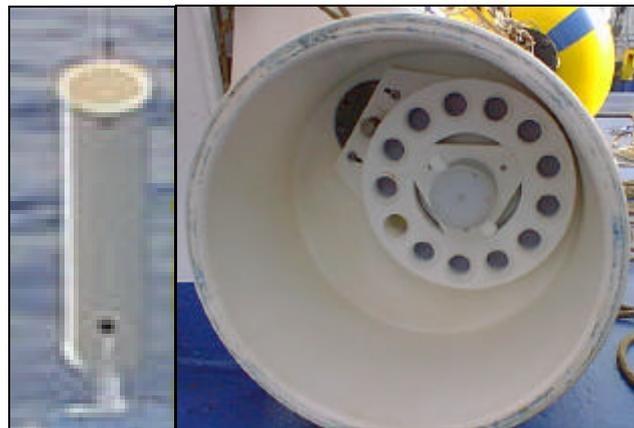
**Due immagini della trappola per sedimenti, dotata di un'apertura conica di 50 cm: a sinistra durante il recupero nel Dicembre '99, a destra un particolare che mostra l'alloggiamento ruotante dei recipienti di raccolta dei sedimenti**
