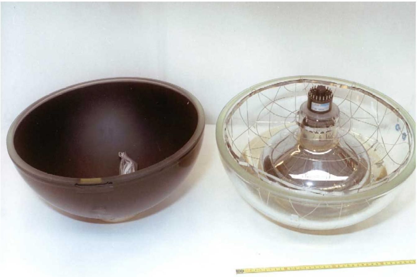
**Figura 2: Benthos Sfera - Particolare delle due semisfere**
