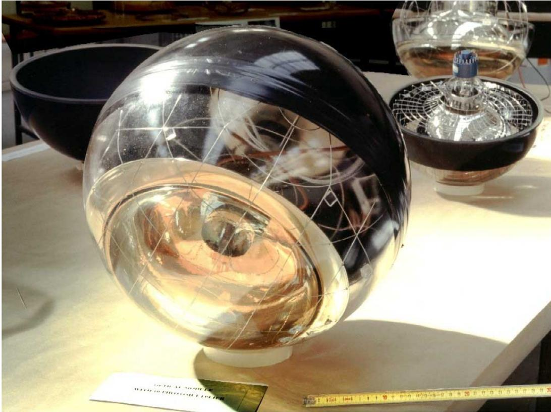
**Figura 1: Modulo ottico assemblato –
