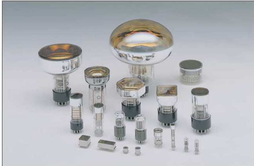
Figura 1.1: Esistono diversi tipi di fotomoltiplicatore in relazione all'utilizzo che ne deve essere fatto. Nei rivelatori di neutrini si impiegano tipicamente PMT con grande area fotosensibile. La fotografia riportata in figura mostra alcuni modelli della casa costruttrice Hamamatsu [6].
