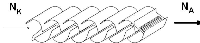
Figura 1.5: Struttura del moltiplicatore elettronico. Le placchette sono affacciate una all'altra per facilitare la connessione e l'uniformità dei cammini elettronici. N_K fotoelettroni generano N_A elettroni in uscita. Il rapporto fra queste due grandezze si chiama guadagno del PMT, il suo valore numerico può raggiungere parecchi milioni.
