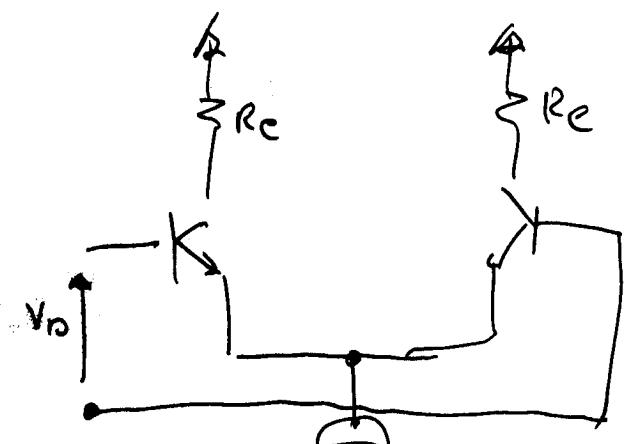
$$V_{BE1} = V_{BE} + \frac{V_D}{2}$$
