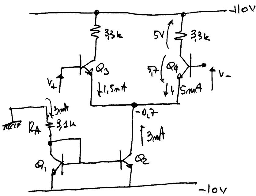
$$R_A = \frac{-0,7 - (-10)}{3 \text{ mA}} = 3,1 \text{ k}\Omega$$
