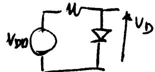
oppure analiticamente fissando  $V_D = 0,7 \times$
