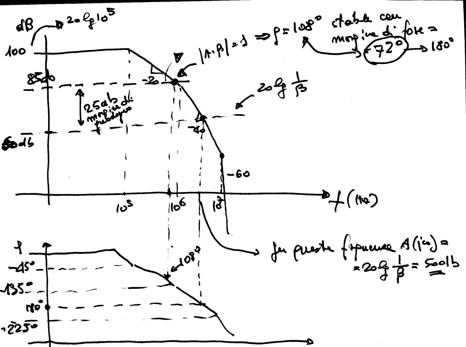
Criterio di stabilità: Linee  $20 \log \left( \frac{1}{\beta} \right)$  intersecano  $20 \log |A|$  in un punto che corrisponde a  $-20 \text{ dB}/10$
