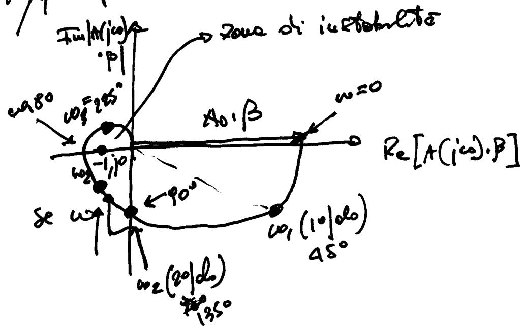
$$\text{a } 180^\circ \Rightarrow \text{Im}[A(i\omega) \cdot \beta] = 0 \Rightarrow \text{Re}[A(i\omega) \cdot \beta] < 1$$
