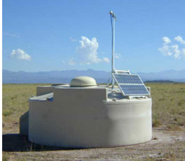
Figura 2.10: Una delle stazioni Cherenkov che costituiscono l'array di superficie dell'esperimento Auger
