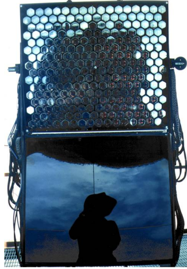
Figura 2.6: Array di fototubi dell'esperimento HiRes
