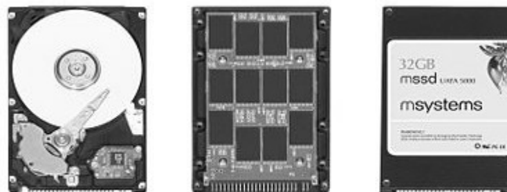
Disco a stato solido confrontato con un comune disco rigido
