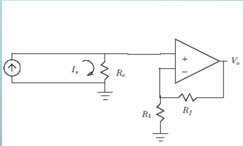
E' praticamente un non invertente con un carico resistivo  $R_c$  che effettua la conversione  $\Rightarrow V_o = R_c I_s A_v$
