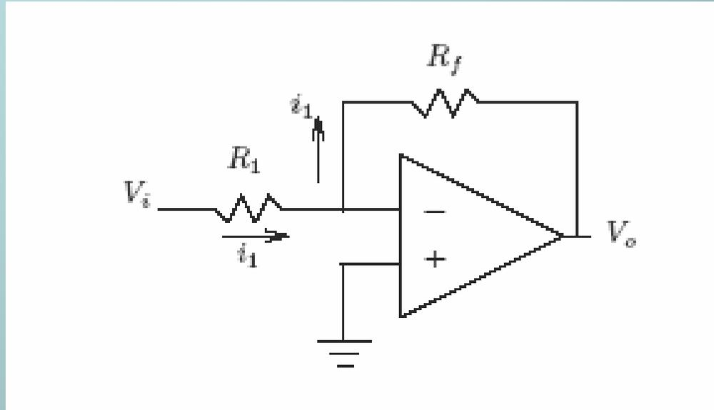
Amplificatore in tensione:  $i_1 = \frac{V_i}{R_1} = -\frac{V_o}{R_f} \Rightarrow A_v = -\frac{R_f}{R_1}$
