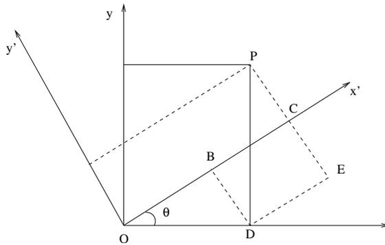
Figura 1.5: Illustrazione della rotazione di un angolo  $\theta$  di un sistema di assi ortogonali.
