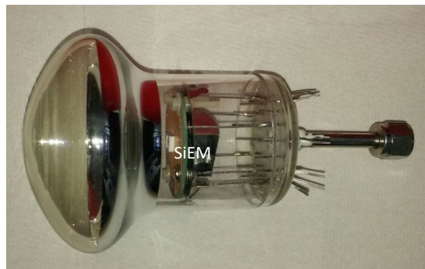
fig.31: vista laterale e frontale del VSiPMT. Si vede chiaramente il posizionamento del SiEM
