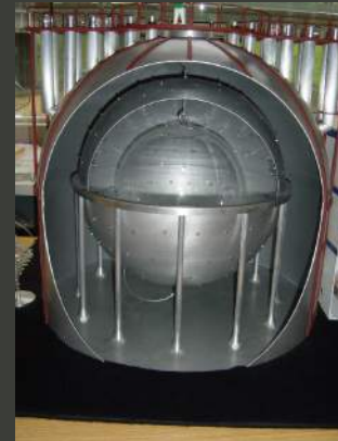
Borexino (> 2007) Liquid scintillator 0.3 kt, 2200 PMTs
