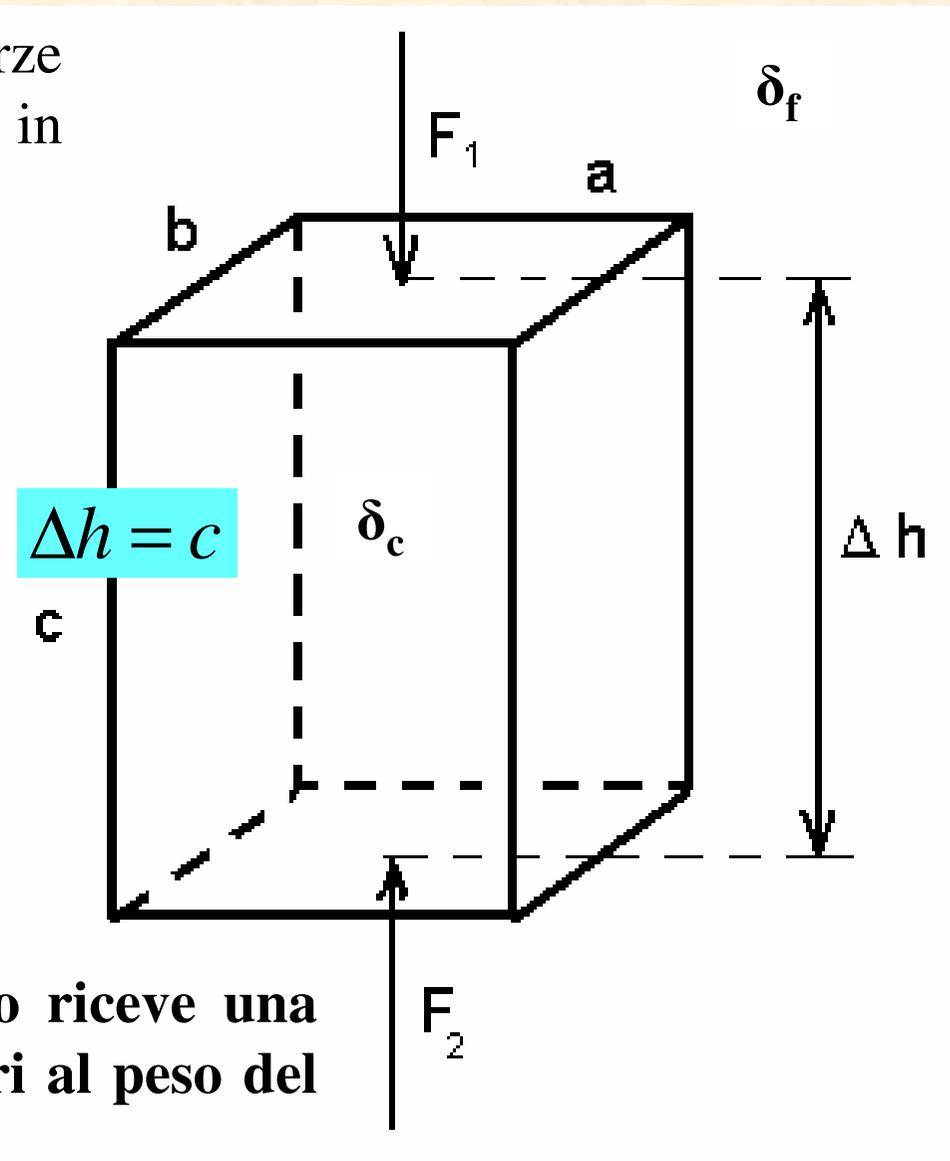
Si consideri un corpo di densità  $\delta_c$  immerso in un fluido di densità  $\delta_f$ . La parte di volume immersa sia  $V''$  e sia il corpo all'equilibrio. In questo caso la risultante della forza peso  $\mathbf{P}$  e della spinta di Archimede  $\mathbf{A}$  è nulla.
