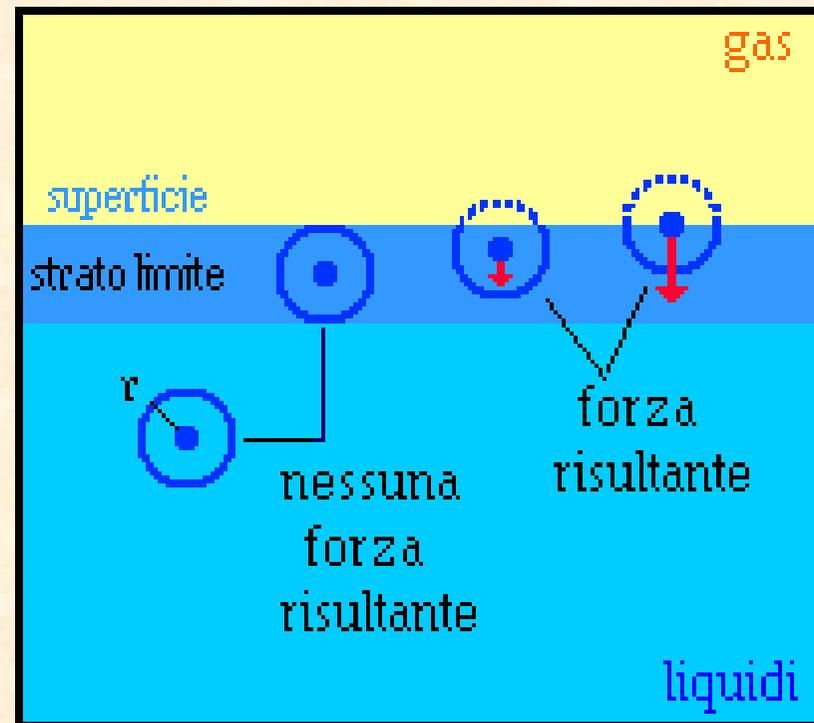
Se una molecola che si trova nello strato limite viene sollevata, i legami tra essa e le molecole adiacenti vengono tesi, generando una forza che tende a richiamare la molecola verso la superficie. Allo stesso modo, appoggiando un corpo minuscolo sulla superficie di un liquido, le molecole superficiali di quest'ultimo vengono spinte verso il basso generando una forza di richiamo diretta verso l'alto.
