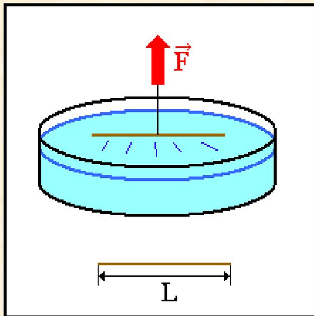
La tensione superficiale viene misurata direttamente misurando la forza necessaria a rompere la superficie del liquido sollevando un filo sottile dalla superficie stessa.
