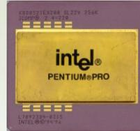
Costituito da **5.5 milioni di transistor integrati a 0.6 micron** e introdotto da Intel nel **Novembre 1995** questo processore superscalare implementa delle nuove tecniche di elaborazione dati che possiamo riassumere in:
