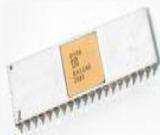
Zilog realizza lo **Z-80**, microprocessore a 8 bit le cui istruzioni sono una evoluzione di quelle dell'Intel 8080
